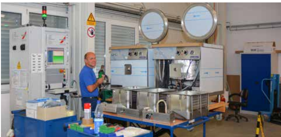
Ein Küchenblock wird vor dem Versand auf dem Prüfstand getestet.
