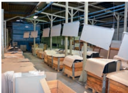
Modulare Edelstahlteile können in einer speziellen Anlage bei Ascobloc in Dresden in allen möglichen Farben pulverbeschichtet werden. In der Praxis ergibt dies dann auch für den Großküchenbereich die Möglichkeit, eine Edelstahlküche attraktiv zu präsentieren und dennoch hygienisch zu arbeiten.
