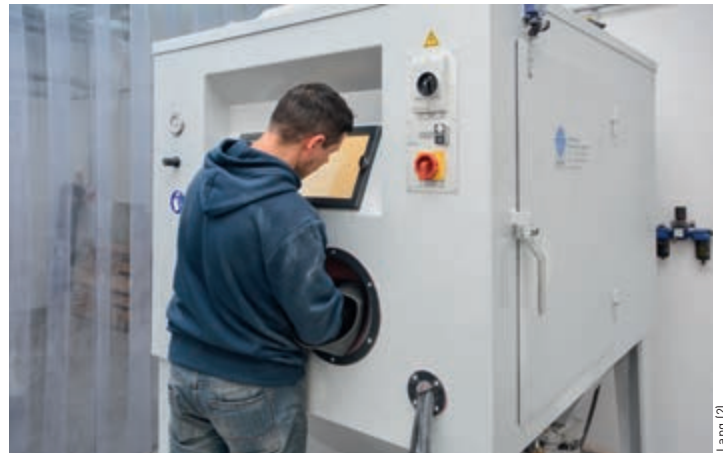
Mehr Kompetenz im eigenen Unternehmen: Ascobloc vertieft das Fertigungs-Know-how wie hier mit einer neuen Anlage, die mit Sandstrahltechnik Bleche in unterschiedlicher Körnung bearbeitet.
