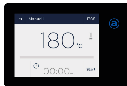
Manuell keine Korbliftsteuerung, manueller Timer mit Signalton
