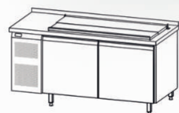
Grundausführung – Eigenkühlung mit Flügeltüren, Maschinenfach links
