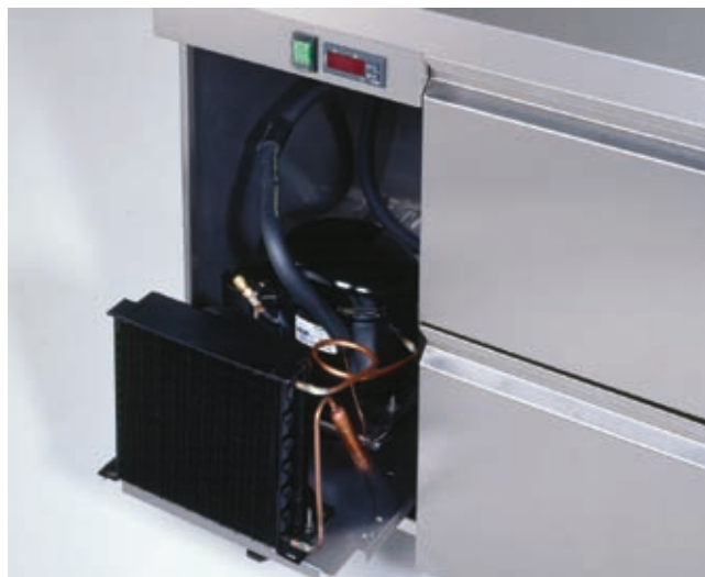
Wysuwany agregat w celu łatwej obsługi serwisowej
