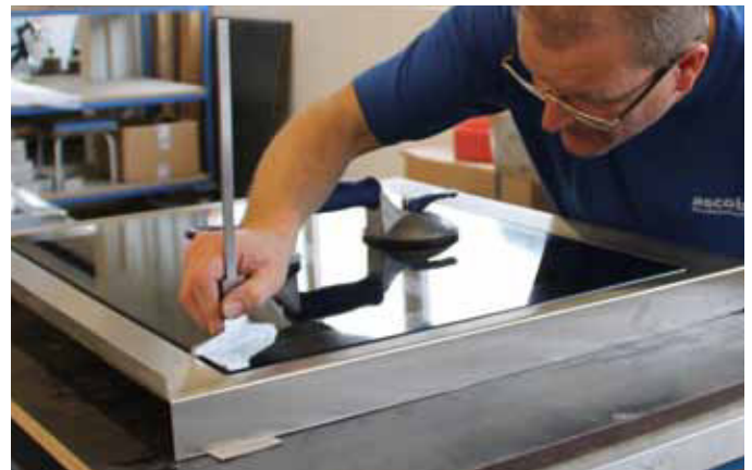
Präzise werden die Ceranfelder verklebt.
